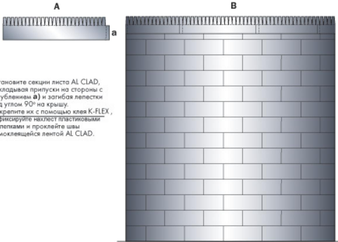
Установите секции листа AL CLAD, накладывая припуски на стороны с углублением **a**) и загибая лепестки под углом 90° на крышу.
