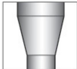
Из листа AL CLAD вырежьте три детали, необходимые для полной установки покрытия переходника [A1-2-3], оставив 5 см на притуски для нахлестов швов. На деталях 1-2 сделайте лепестки по верхнему краю.
